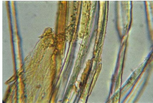
Fig3. Fibras de urdimbre de la muestra de radiocarbono, 800x en agua. La goma se hincha, volviéndose más transparente y se desprende de las fibras.
